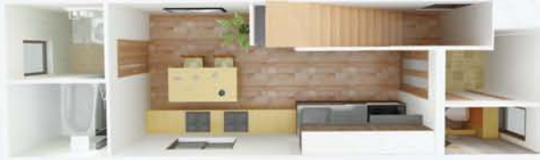
1F 2m40cmのシステムキッチンの後ろの階段下は、冷蔵庫家電収納、食器収納があり、収納量たっぷり。リビングスペースのベンチシート下も床下スペースを利用した収納になっています。
